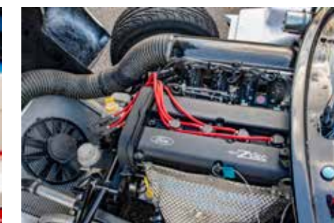
► Ford Zetec-motor på 1,8 liter och 165 hästkrafter ger bra körbarhet och bra tillförlitlighet.
