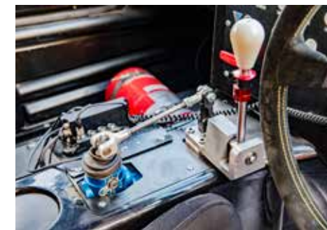
► Sekventiell sexväxlad låda från Quaife. Spaken på perfekt avstånd från ratten.
